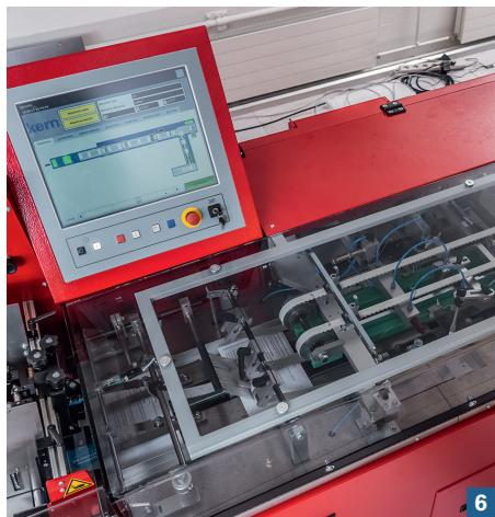
Die eingebaute Logik entscheidet – je nach Applikation – ob ein Dokument oder eine Dokumentengruppe gedreht (in beide Richtungen möglich) werden muss, um entsprechend der Fensterposition ins Kuvert geschoben werden zu können.
