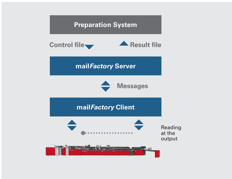
Mit mailFactory DocumentControl erfolgt eine direkte Steuerung der Verarbeitung auf Grund der Lesung am Eingang des Kuvertiersystems. Die Sendung wird identifiziert und auf Blattebene überwacht. Anweisungen zur Sendungszusammenstellung oder Sortierung am Ausgang können aus der Steuerdatei erfolgen (dateigesteuertes Verpacken).
