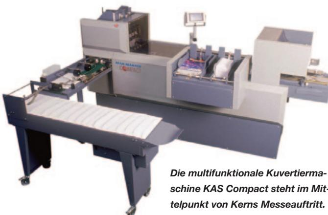
*Die multifunktionale Kuvertiermaschine KAS Compact steht im Mittelpunkt von Kerns Messeauftritt.*
